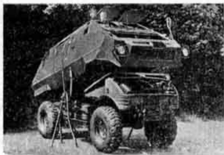
Рис. 1. Замена корпуса бронированной машины «Рейншталь» UR416 Фото из журнала «Интернэшнл дефенс ревью»
